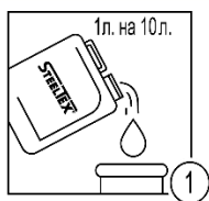
Шаг 1 - Приготовление промывочного раствора
