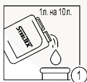
Шаг 1 - Приготовление промывочного раствора
