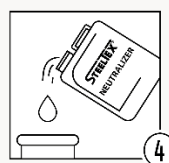
Шаг 4 - Нейтрализация кислотности теплообменника
